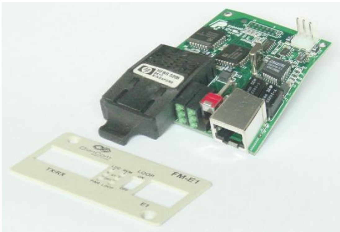
Рис.3. Внешний вид модема FM-E1 для установки в шасси FMS-6MC.
